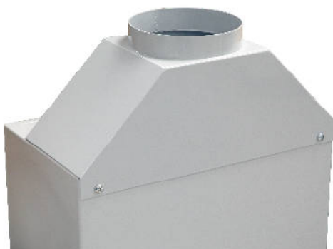
Der optionale Abluftstutzen ist auf dem Klimagerät montiert und ermöglicht den direkten Anschluss eines Abluftschlauches an das Kühlgerät. Die Warmluft kann so direkt nach außen geleitet werden und ein Aufheizen des Aufstellungsraumes wird verhindert.
